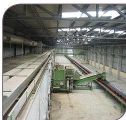
Cette technique est la plus utilisée en Europe avec plusieurs centaines d'installations mises en fonctionnement depuis la fin des années 90. Elle consiste à construire de grandes salles de compostages divisées en tunnels en béton, fermés de portes isolantes. De l'air est
