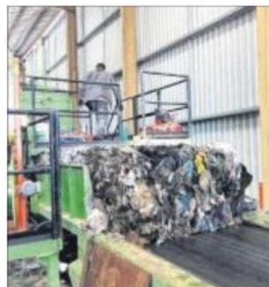
Les déchets sont compactés avant d'être cerclés et recouverts de 20 couches de film plastique.
