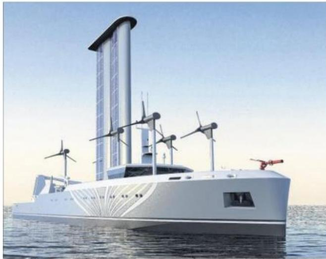
Avec ses six éoliennes et ses 700 mètres carrés de panneaux photovoltaïques, ce navire à la pointe de la technologie sera entièrement autonome en énergie.
