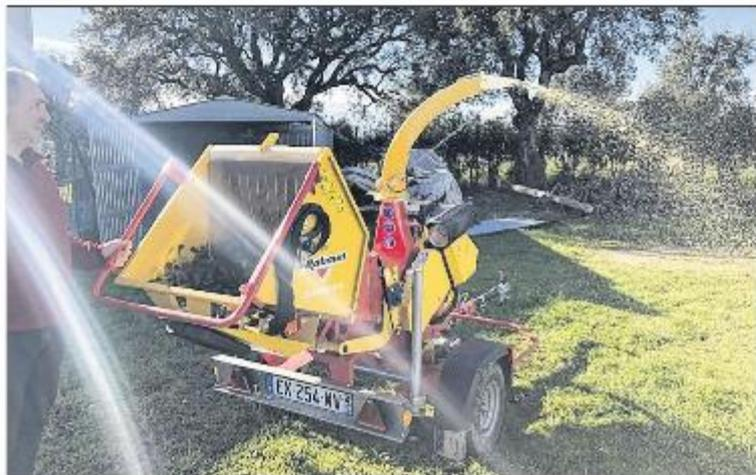
La machine permet de broyer des branches d'un diamètre allant jusqu'à 15 cm.
