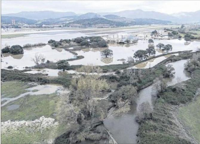
Entre 400 et 500 000 m<sup>3</sup> d'eau se sont déversés sur la piste de l'aéroport lors de la crue centennale de la Gravona, fin décembre, le tronçon CCM de la digue - qui s'étend sur 2 300 mètres jusqu'à l'embouchure - n'ayant pas rompu mais ayant subi une surverse. / DOC CM
