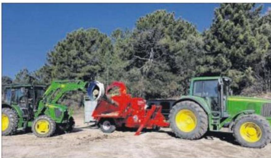
L'entreprise Alta Rocca Élagage a en charge la coupe des pins sur la parcelle à la sortie du village. Une pince mécanique est utilisée pour déposer les troncs dans le broyeur. /PHOTO CCAR
