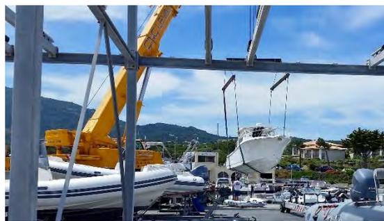
**Figure 20** : Grue élévatrice en train de mettre un bateau à l'eau au port de Sant Ambroggio
