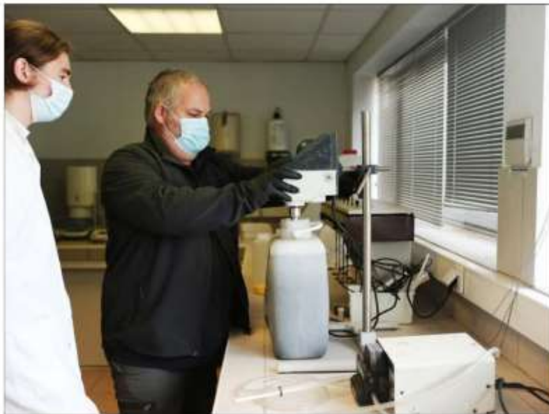
Pierre Giacomi (à droite), le chef du service qualité, en train d'homogénéiser le bidon renfermant les prélèvements effectués pendant 24 heures dans le canal alimentant l'usine de dépollution de la Marana.
