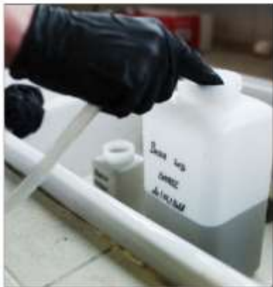
Des prélèvements de 100 ml sont ensuite expédiés au laboratoire des eaux de Paris qui se charge de les analyser.
