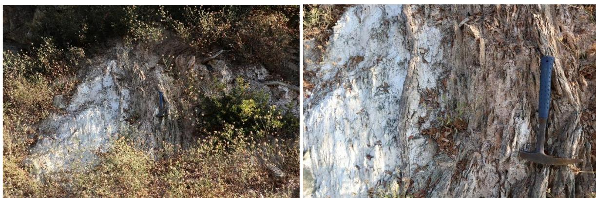
Figure 100 : Amas blanchâtre fibreux, probablement à trémolite-amiante, dans des serpentinites intercalées dans des metabasaltes à actinolite (affleurement CC397, Voie ferrée, PK41+100).
