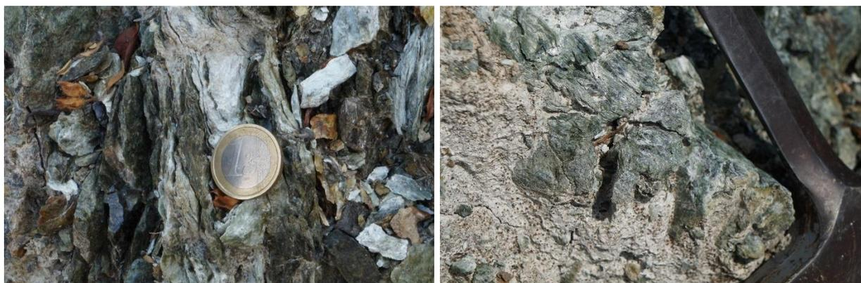
Figure 99 : Contact entre les metabasaltes et les métagabbros souligné par un amas blanchâtre fibreux à trémolite-amiante (affleurement CC316). À gauche : amas blanchâtre fibreux à trémolite-amiante. À droite : plan serpenteux de chrysotile (affleurement CC316).
