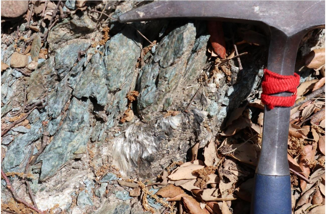
*Figure 123 : Passée de serpentinites à nombreux plans à longues fibres souples (trémolite-amiante probable), voie ferrée, affleurement CC410.*
