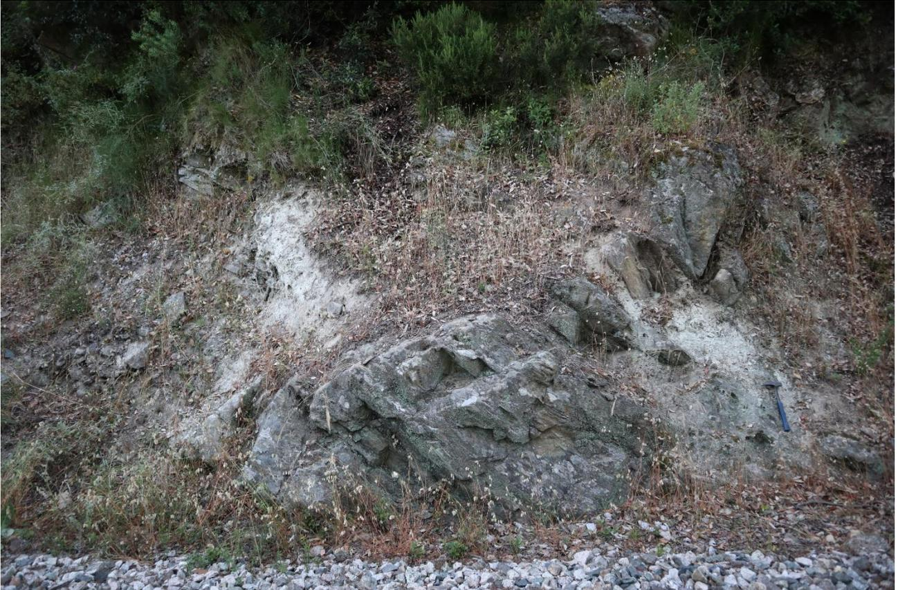
*Figure 127: Métabasaltes rétro-morphosés, très déformés, à niveaux de talcschistes fibreux probablement amiantifères, affleurement CC406, Voie ferrée (PK36+100).*
