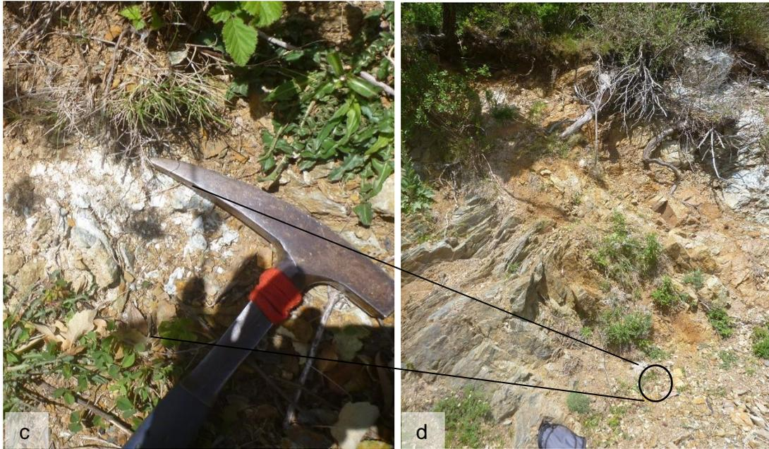
Figure 224 : Affleurement de serpentinites à la sortie du village de Vignale, affleurement CC002. a, Plan de chrysotile (amiante). b, état général des serpentinites à l'affleurement. c et d, occurrence amiantifère au contact avec les metabasaltes.
