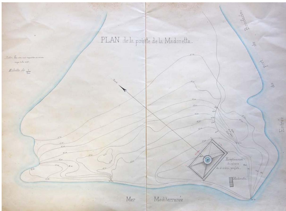
*Plan de la pointe de la Madoneta (1852) avec l'emplacement du phare projeté. Sur ce plan original ne figurent pas les murs d'enceinte et le chemin d'accès au phare, qui seront faits ultérieurement : cela posa de gros soucis au chantier, tous les approvisionnements devant se faire par bateau, et donc soumis aux conditions de navigation.*
