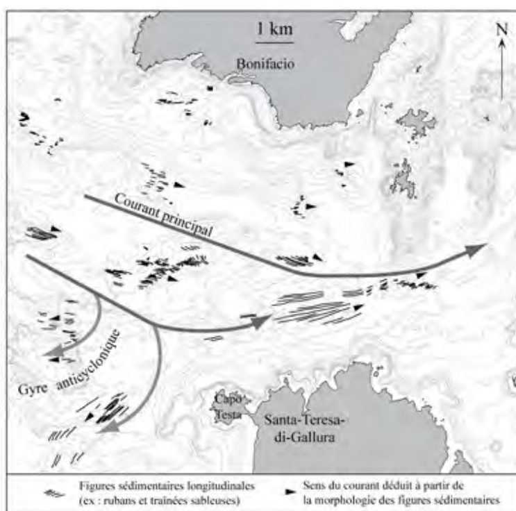
Figure 32 Cartographie des figures sédimentaires longitudinales et sens des courants déduits à partir de la morphologie des formes sédimentaires (in Orsini et al. 2011a)
