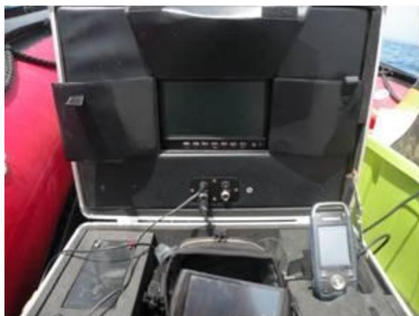
Figure 35 : Console d'acquisition vidéo drop-camera (© Sintinelle)
