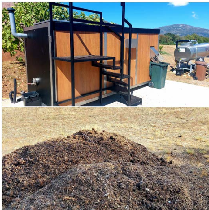
La mise en place d'un composteur électromécanique dans la prison de Borgo a permis de traiter 150 kg / jour de biodéchets provenant des cuisines centrales, du mess, des personnels et camos de gendarmerie voisins..
