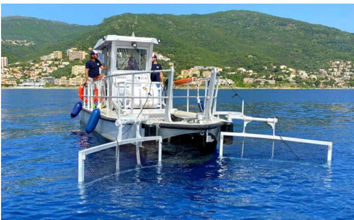
Le navire de dépollution de Mare Corsica permet une collecte par aspiration des déchets plastiques sur l'ensemble du littoral. Il est également utilisé pour des animations pédagogiques à destination des scolaires (photo de droite : animation pédagogique sur le port de Tizzano © Mare Corsica)
